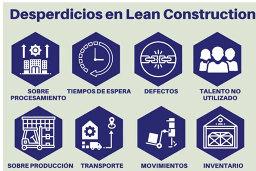
Figura 3 Tipos de desperdicios clasificados por Lean Construction
