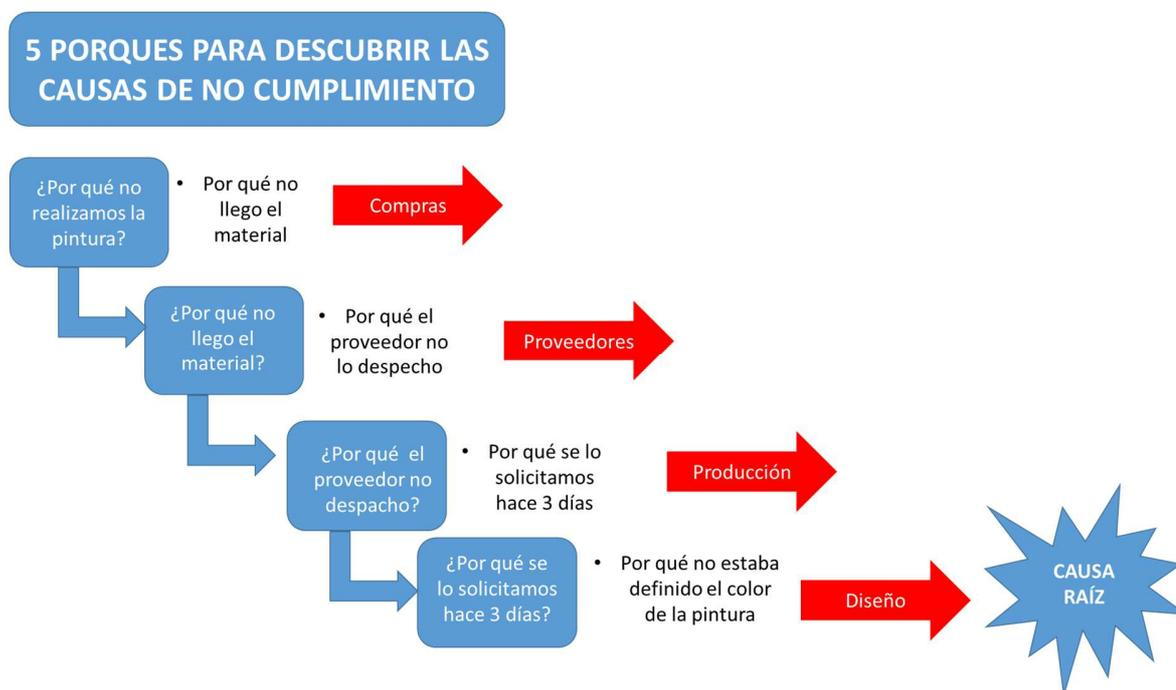
Figura 12 Diagrama del enfoque de los 5 porque
