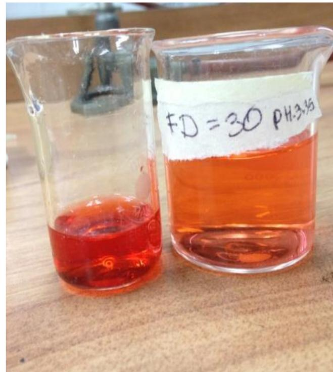
La  $\lambda_{\text{máx}}$  determinada en el espectro de absorción máxima fue de 508 nm. El valor de la absorbancia en esta longitud de onda se utilizó posteriormente para el método del pH diferencial.
