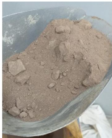
Figura 4. Cenizas volantes.
