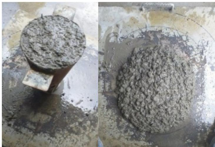
Figura 19. Ensayo de escurrimiento con concreto fresco en serie P3.
