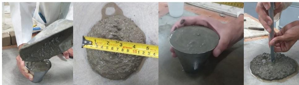
Figura 12. Pruebas de aditivos con mortero.
