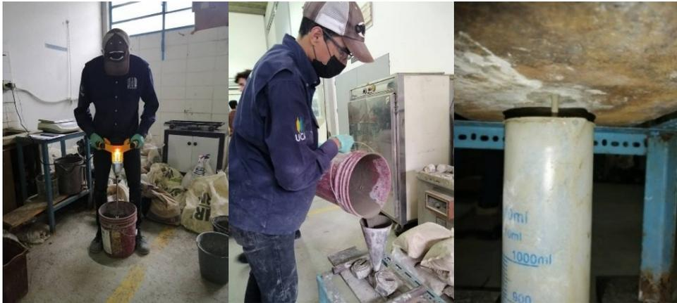
Figura 10. Pruebas de aditivos con pasta de cemento.
