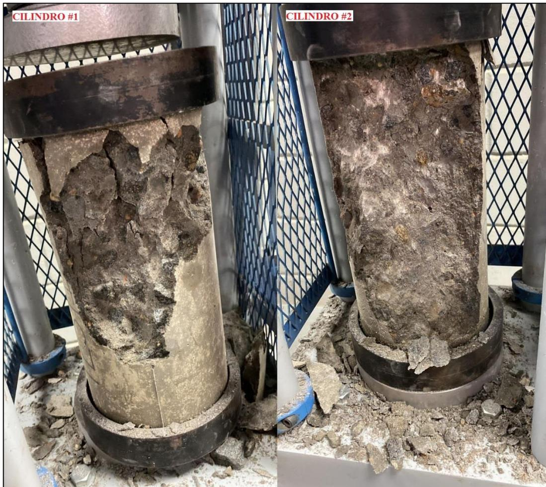
*Figura 35. Modos de falla del concreto con sustitución de 15% (G5) a 90 días. Tomado por Velásquez y Zakhia, 2021, Venezuela. Derechos reservados por autores.*
