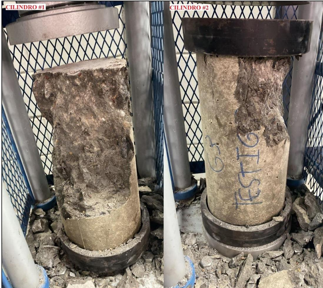
*Figura 34.* Modos de falla del concreto con sustitución de 15% (G3) a 90 días. Tomado por Velásquez y Zakhia, 2021, Venezuela. Derechos reservados por autores.
