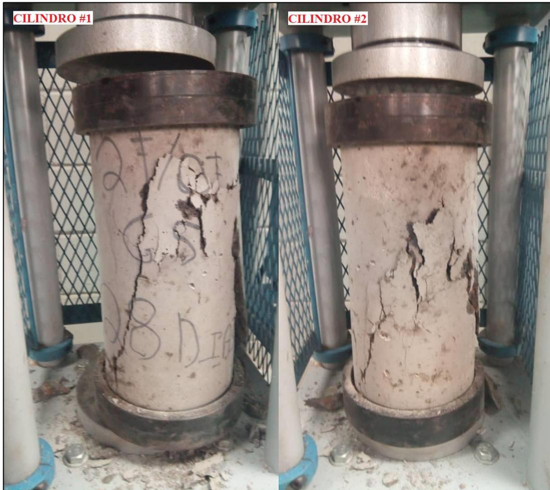
*Figura 33. Modos de falla del concreto con sustitución de 15% (G5) a 28 días. Tomado por Velásquez y Zakhia, 2021, Venezuela. Derechos reservados por autores.*
