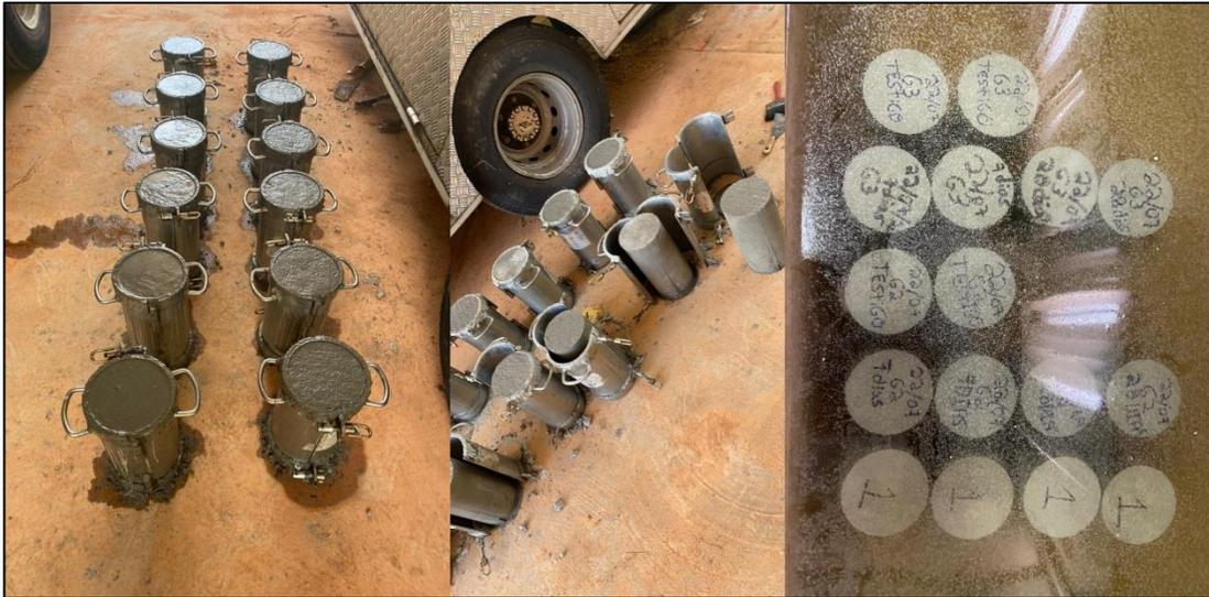
*Figura 12.* Proceso de llenado de los cilindros, desacoplado de los mismos y curado de las probetas. Tomada por Velásquez y Zakhia, 2021, Venezuela. Derechos reservados por autores.
