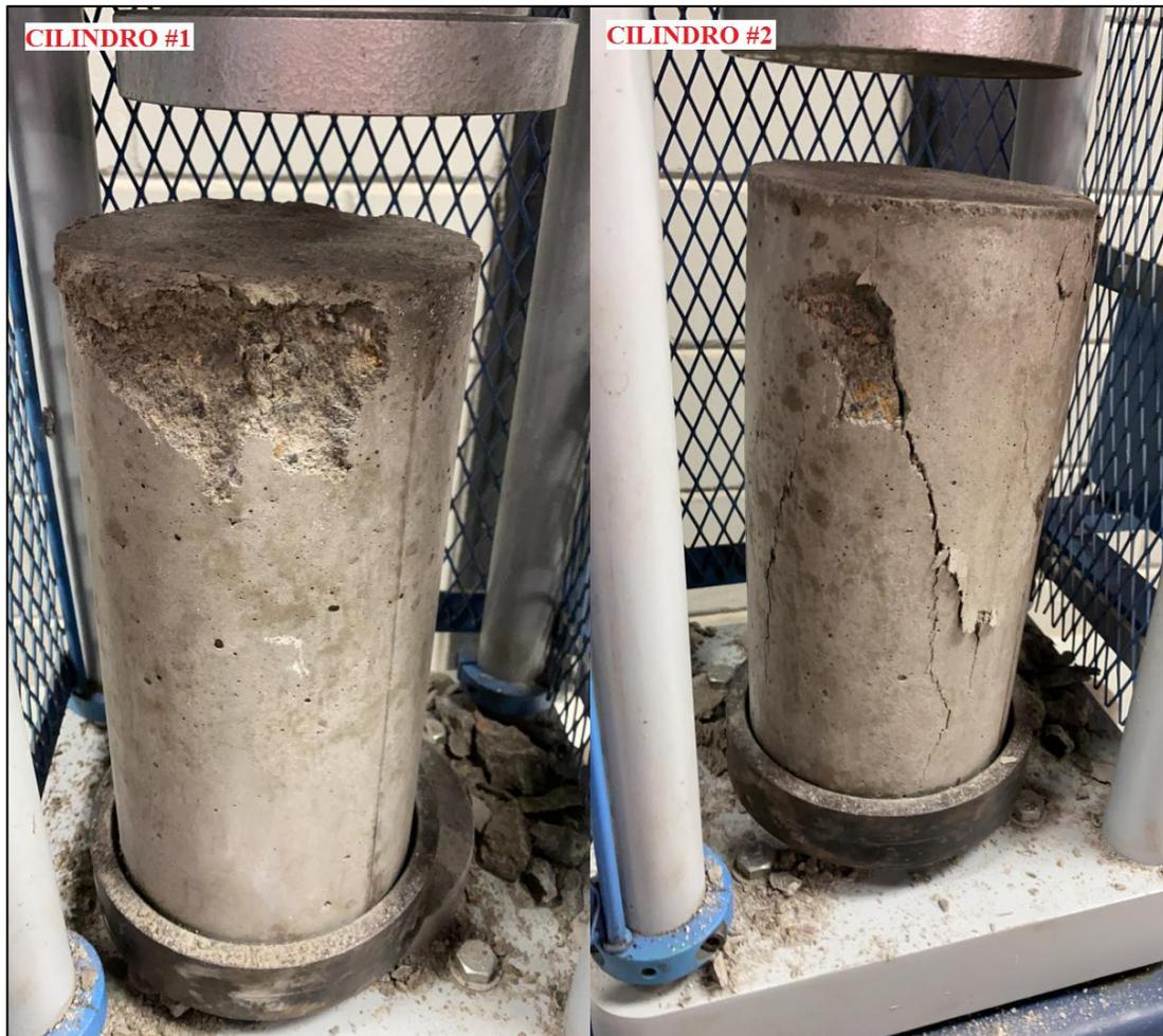
*Figura 31. Modos de falla del concreto con sustitución de 15% (G5) a 7 días. Tomado por Velásquez y Zakhia, 2021, Venezuela. Derechos reservados por autores.*
