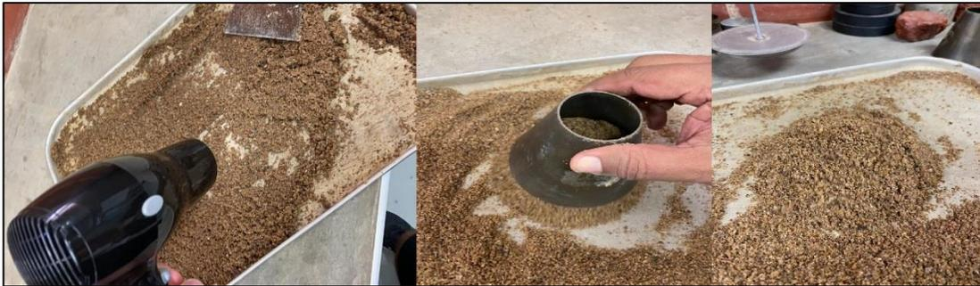
*Figura 9.* Procedimiento para obtener arena saturada con superficie seca. Tomada por Velásquez y Zakhia, 2021, Venezuela. Derechos reservados por autores.
