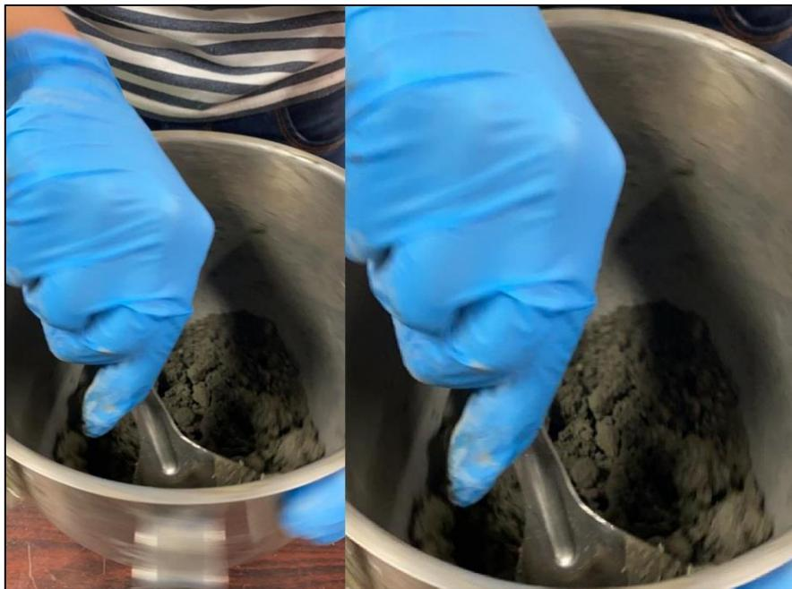
*Figura 11.* Mezclado de la pasta de cemento para obtener la consistencia normal. Tomada por Velásquez y Zakhia, 2021, Venezuela. Derechos reservados por autores.
