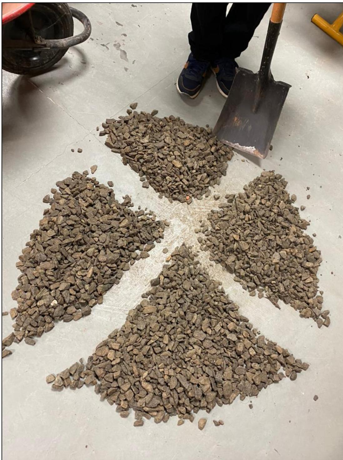
*Figura 41.* Separación de la muestra de agregado fino para ensayo de peso unitario. Tomado por Velásquez y Zakhia, 2021, Venezuela. Derechos reservados por autores.
