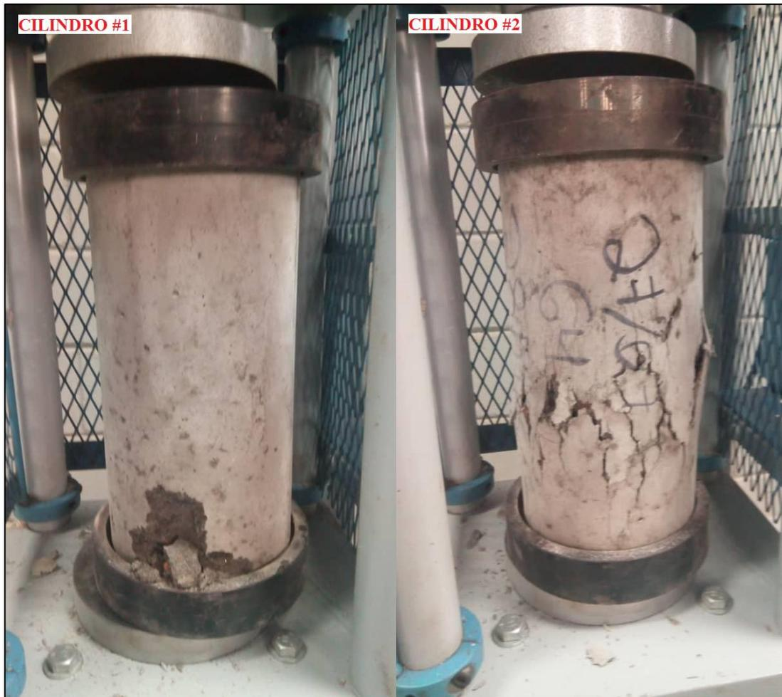
*Figura 27. Modos de falla del concreto con sustitución de 10% (G4) a 28 días. Tomado por Velásquez y Zakhia, 2021, Venezuela. Derechos reservados por autores.*
