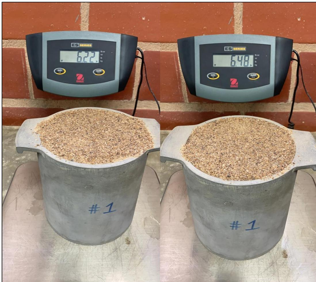
*Figura 43.* Muestra de agregado fino para peso unitario suelto. Tomado por Velásquez y Zakhia, 2021, Venezuela. Derechos reservados por autores.
