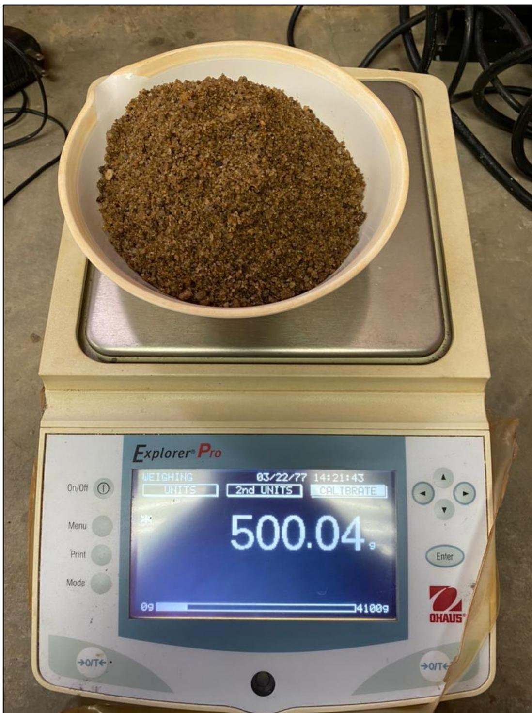
*Figura 46.* Muestra de agregado fino para ensayo de densidad y absorción. Tomado por Velásquez y Zakhia, 2021, Venezuela. Derechos reservados por autores.
