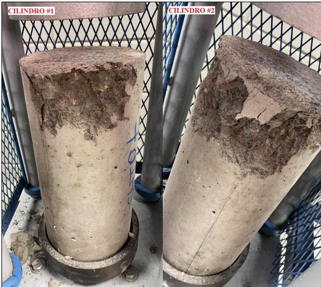
*Figura 24. Modos de falla del concreto con sustitución de 10% (G2) a 7 días. Tomado por Velásquez y Zakhia, 2021, Venezuela. Derechos reservados por autores.*
