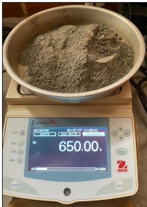
*Figura 16.* Cantidad de cemento para ensayo de consistencia normal. Tomada por Velásquez y Zakhia, 2021, Venezuela. Derechos reservados por autores.
