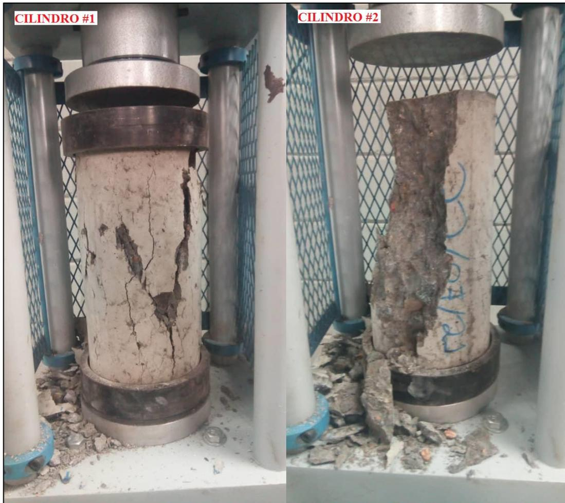
*Figura 26. Modos de falla del concreto con sustitución de 10% (G2) a 28 días. Tomado por Velásquez y Zakhia, 2021, Venezuela. Derechos reservados por autores.*
