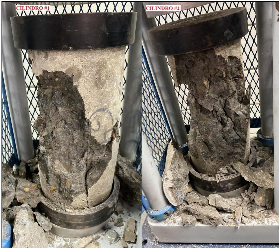
*Figura 29. Modos de falla del concreto con sustitución de 10% (G4) a 90 días. Tomado por Velásquez y Zakhia, 2021, Venezuela. Derechos reservados por autores.*
