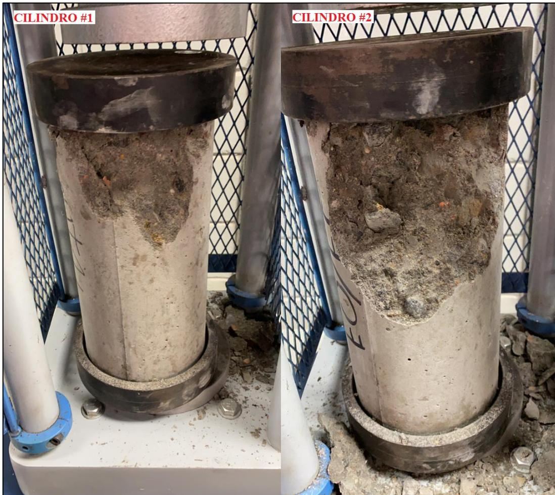
*Figura 25. Modos de falla del concreto con sustitución de 10% (G4) a 7 días. Tomado por Velásquez y Zakhia, 2021, Venezuela. Derechos reservados por autores.*
