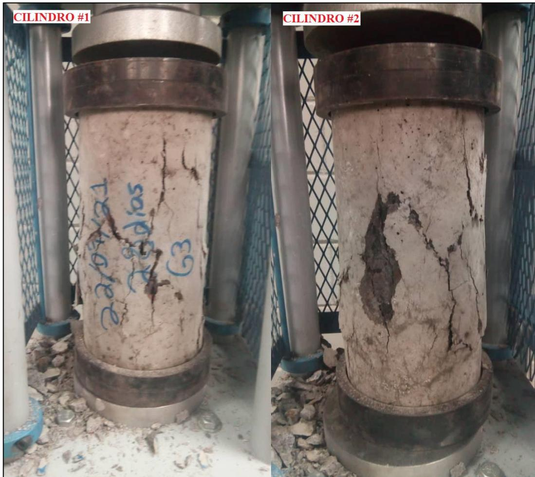
Figura 32. Modos de falla del concreto con sustitución de 15% (G3) a 28 días. Tomado por Velásquez y Zakhia, 2021, Venezuela. Derechos reservados por autores.
