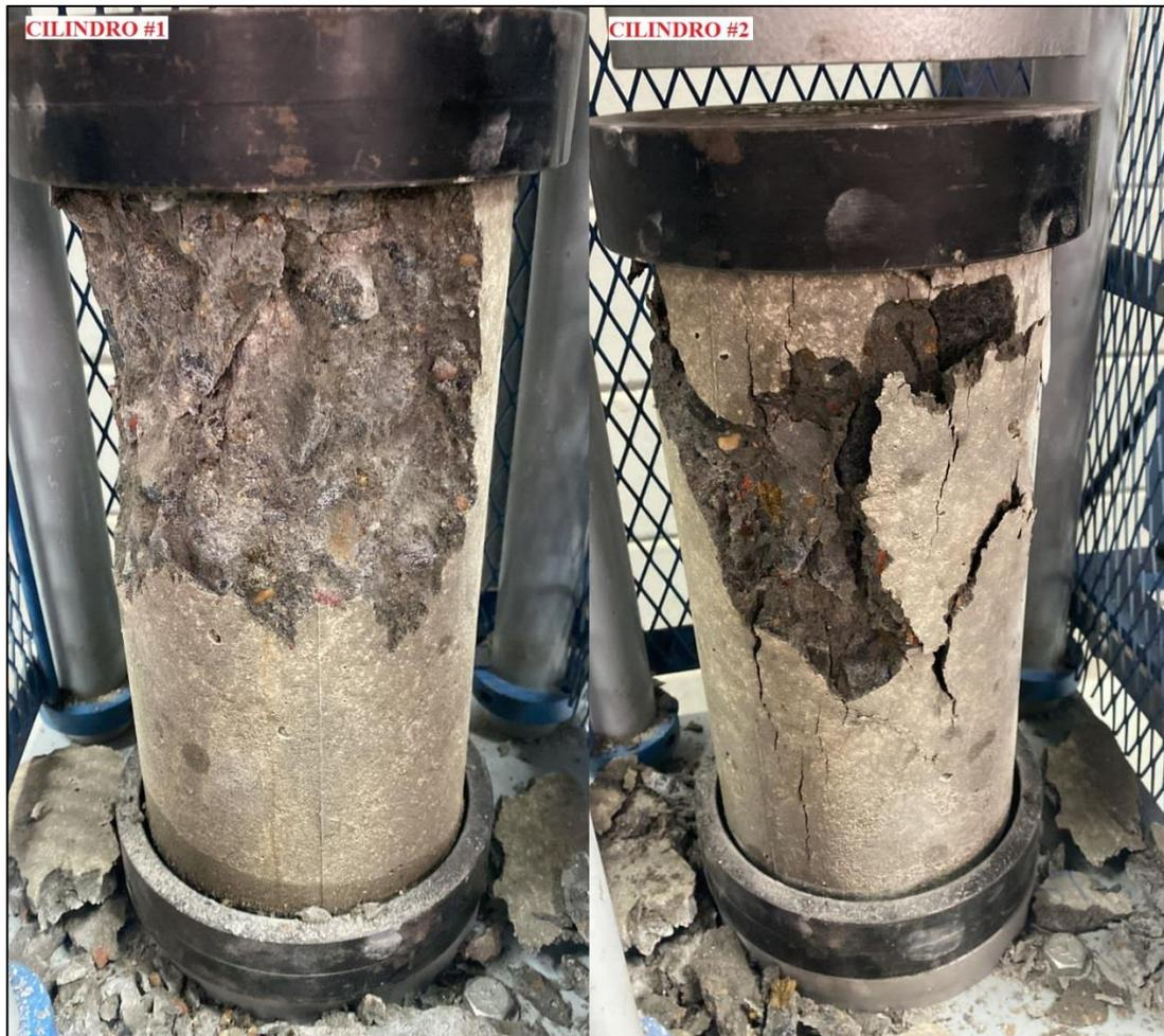
*Figura 28.* Modos de falla del concreto con sustitución de 10% (G2) a 90 días. Tomado por Velásquez y Zakhia, 2021, Venezuela. Derechos reservados por autores.
