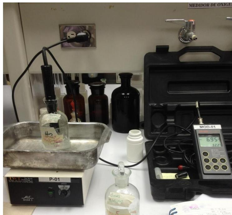
Medición de oxígeno disuelto de la muestra encima de la plancha agitadora.
