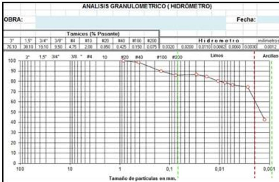
Fig. 2-16 Pruebas de granulometría por hidrómetro a muestras del oriente venezolano con baja Gs. Tomada de [18].
