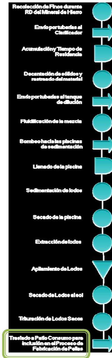
Figura 16: Diagrama de Flujo del Proceso de Producción de Lodos
