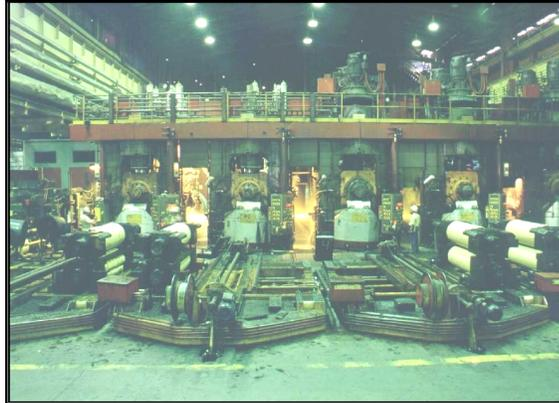
**Figura 5: Tandem - Laminación en Frío**
