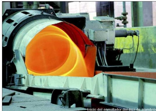
**Figura 6: Formador de Espiras - Planta de Alambón**
