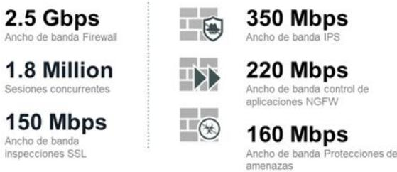
Fig. 12: Especificaciones Firewall FortiGate 50E [14].
