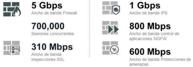
Fig. 13: Especificaciones Firewall FortiGate 40F [15].
