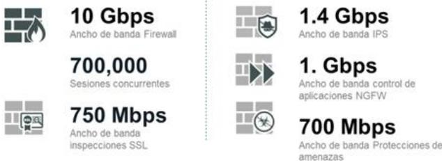
Fig. 11: Especificaciones Firewall FortiGate-60F [13].
