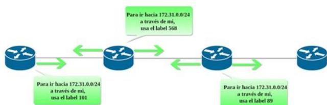
Fig. 1: Funcionamiento MPLS [1].
