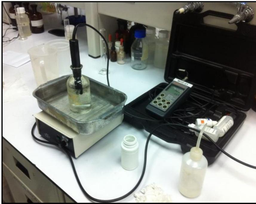
Anexo 2.1. Ensayo del  $\text{DBO}_5$
