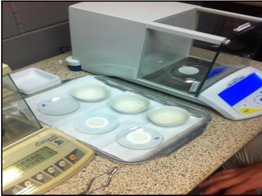
Anexo 4.1. Determinación de peso de los instrumentos para ensayo de sólidos totales
