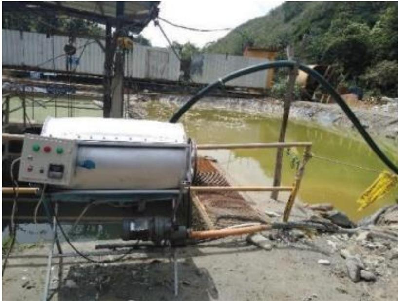
*Figura 25. Sistema de biodiscos en funcionamiento. Tomado de *Tratamiento de aguas residuales mediante biosdiscos en la planta de beneficio Reina del Cisne, El Pache-Portovelo-El oro* (p.67), por Boanerges Correa y Joseph Mocha, 2021, Ecuador. Derechos reservados por Boanerges Correa y Joseph Mocha*
