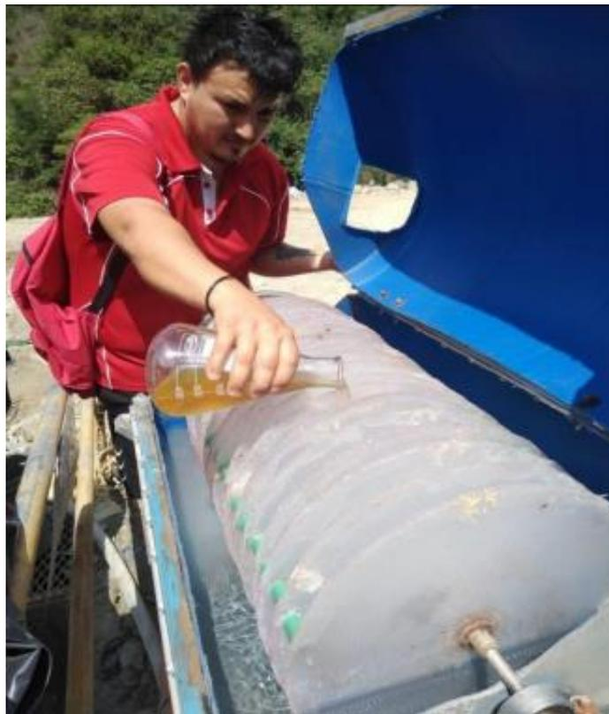
*Figura 24. Aplicación de inóculos al sistema de biodiscos. Tomado de Tratamiento de aguas residuales mediante biodiscos en la planta de beneficio Reina del Cisne, El Pache-Portovelo-El oro (p.69), por Boanerges Correa y Joseph Mocha, 2021, Ecuador. Derechos reservados por Boanerges Correa y Joseph Mocha*
