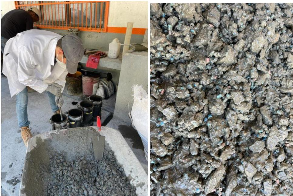
*“Incidencia de plástico reciclado peletizado como agregados en el concreto”.*
