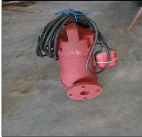
*Figura 13.* Bomba sumergida usada en el clarificador (sedimentador secundario). Fuente: Propia.
